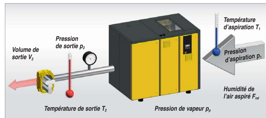
Fig. 1 : Mesurage du débit selon ISO 1217 annexe C (DIN 1945 annexe F)
