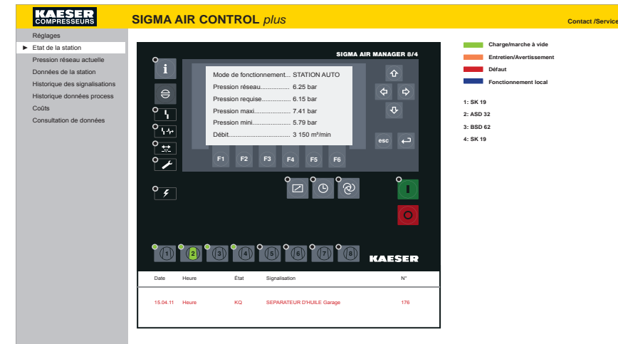
Fig. 5c : Aperçu général : commande et système de gestion
