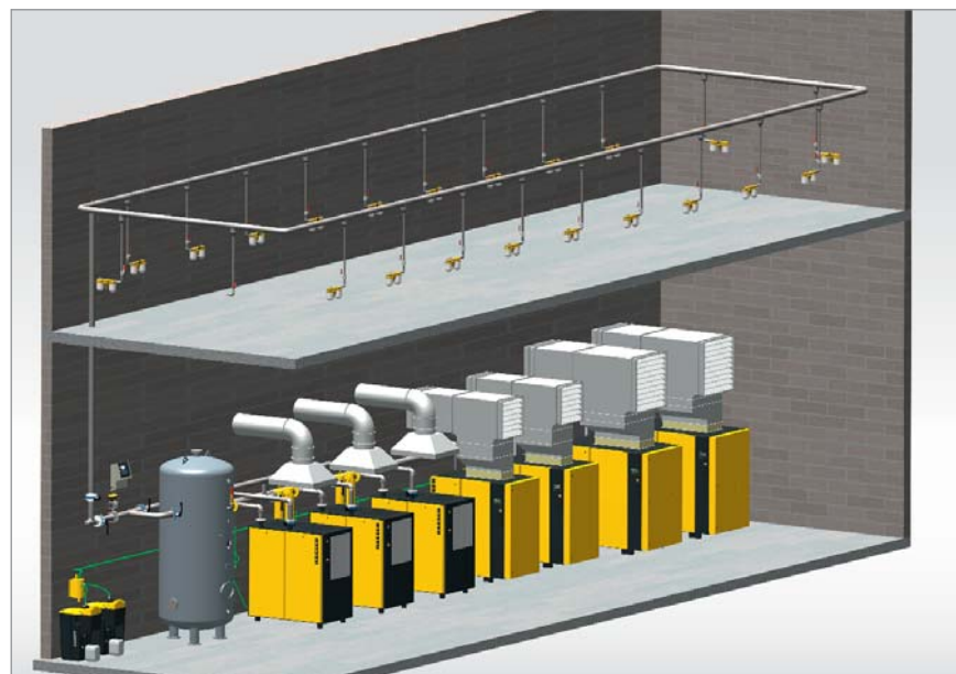
Exemple d'une station avec un système d'évacuation d'air chaud et une ventilation thermostatée supplémentaire pour le sécheur frigorifique
