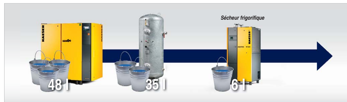
Fig. 1 : La production, le stockage et le traitement de l'air comprimé génèrent des condensats (quantités indiquées pour 10 m 3 /min, 10 bar abs , 8 h, 60 % F rel et 20 °C)
