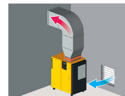
Fig. 3 : Ventilation forcée : gaine d'évacuation d'air chaud, pour les centrales à partir de 11 kW
