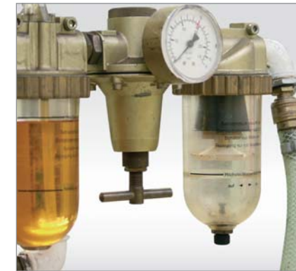
Fig. 6 : Unité d'entretien avec manodétendeur
